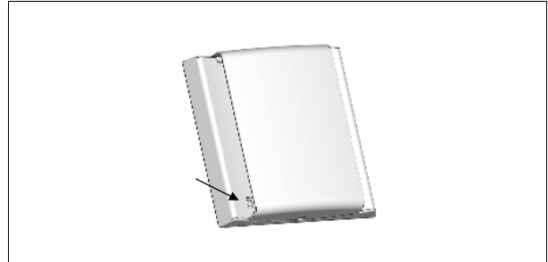
4.1 Positie luchtkwaliteitssensor op de binnenwandrooster.
